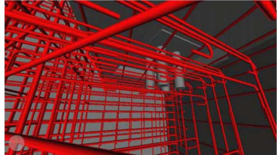
配筋モデル(支沓アンカー箱抜き)
